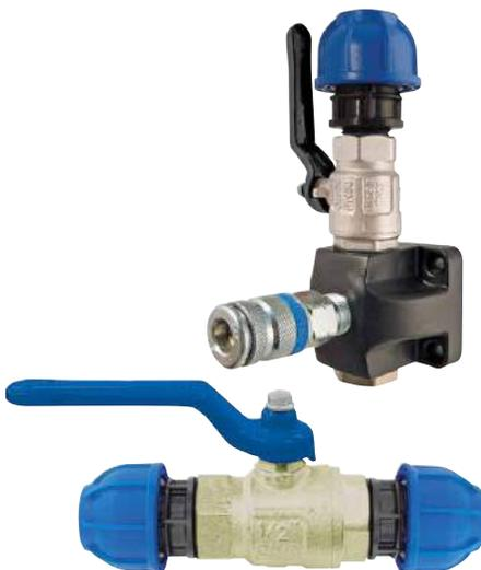
« L'ajout de robinets quart de tour est une solution idéale pour faire l'entretien des équipements sans avoir à dépressuriser le système. Nous en avons installé à plusieurs endroits de sorte qu'une machine brisée peut être isolée. Ceci permet aux autres machines de fonctionner pendant la réparation. Il est alors plus facile de planifier notre production, car moins d'imprévus surviennent ».
